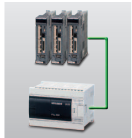
Direktes Motion Control für bis zu drei Achsen ohne zusätzliche Hardware
